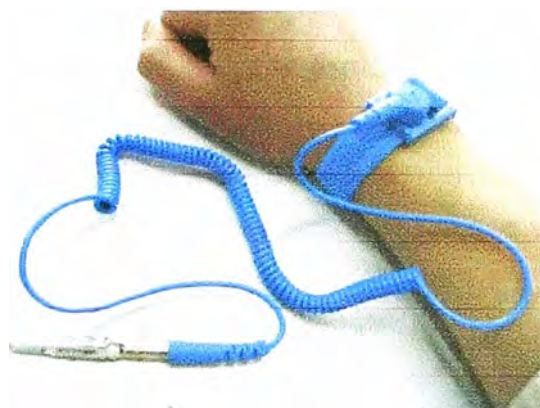
Figura 2.11 Configuración de conexión a tierra para la pulsera (Fuente: Poirot S.A.)
