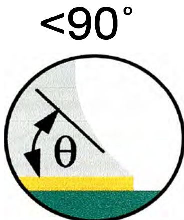
Figura 2.21 Menisco cóncavo (Fuente: Estandar IPC-A-610E)
