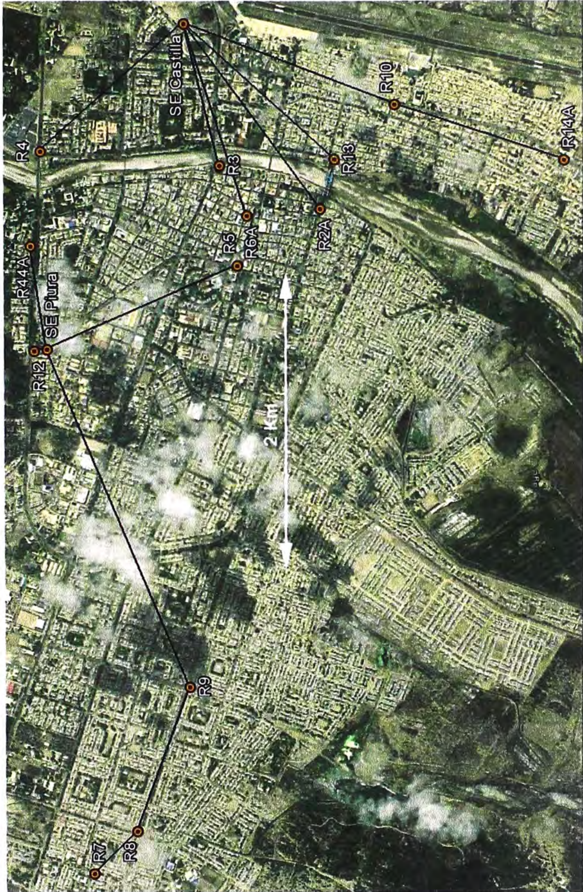
Figura 3.1 Topología de la solución inalámbrica Unidad de Negocios Piura (Fuente: Path Loss, Google Earth)
