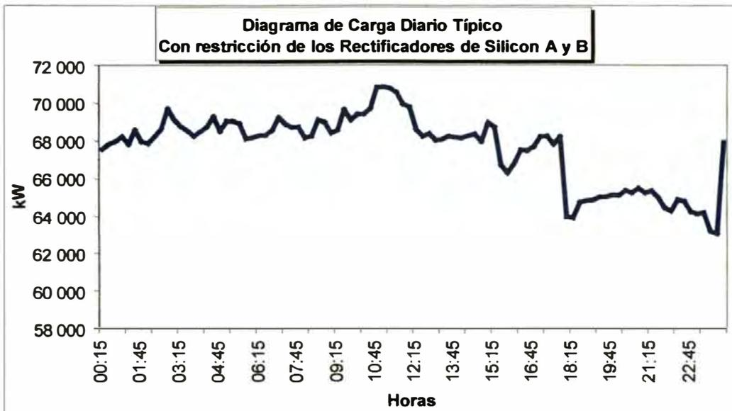
El diagrama de carga que continua es representativo del comportamiento de la carga en un día típico de demanda sin restricción de la carga, en las horas de punta, en los rectificadores de Silicón A y B.
