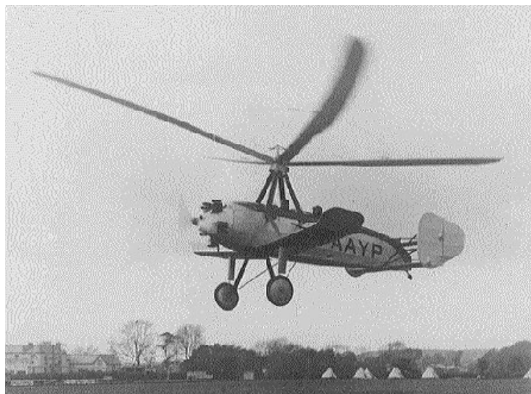
Figura 1.21: El autogiro de Juan de la Cierva fue un dispositivo híbrido con alas y cola, pero también con un rotor vertical sobre el fuselaje.
