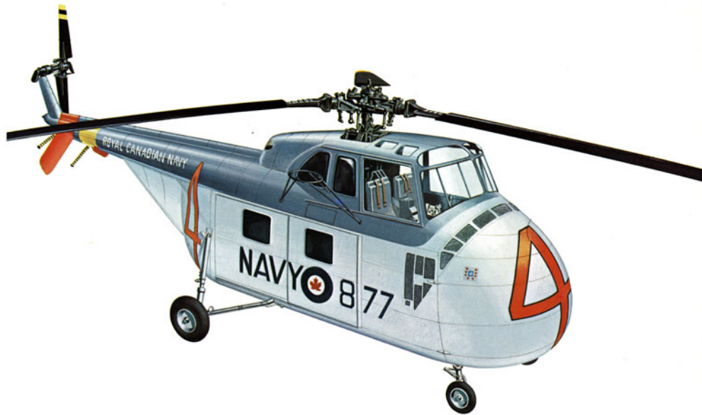
Figura 1.24: Al colocar el motor en la proa del S-55, un helicóptero que se usó mucho en Korea, Sikorsky consiguió espacio para una cabina con capacidad para 10 personas. El motor se conectaba al rotor por medio de un árbol de transmisión inclinado que pasaba entre los asientos de una carlinga. El aparato que se reproduce aquí luce los colores de la Marina Real canadiense que utilizó el S-55 para misiones de rescate.
