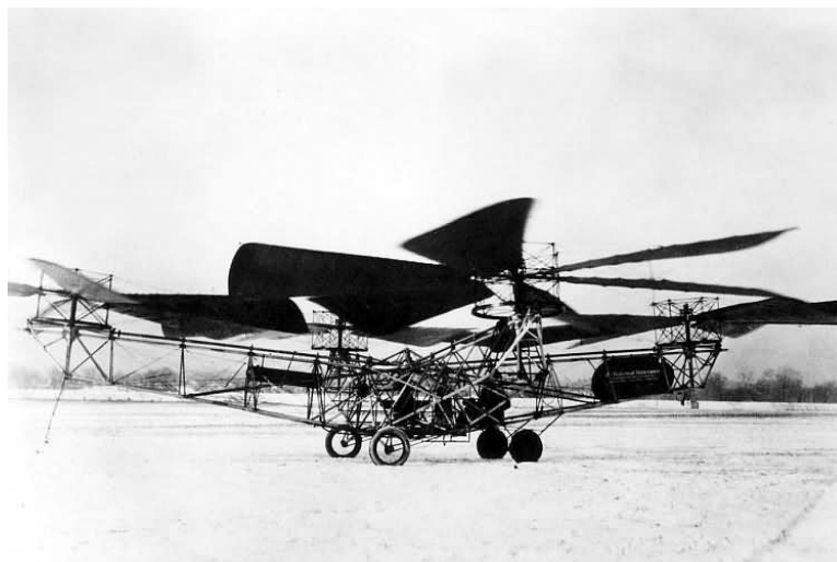
Figura 1.20: El helicóptero de Bothezat con seis rotores de palas (1922) fue respaldado por la armada estadounidense.
