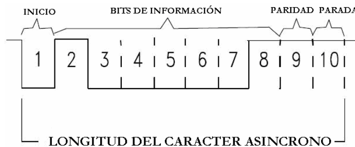
Fig. 3.2. Estructura de transmisión asíncrona de datos.
