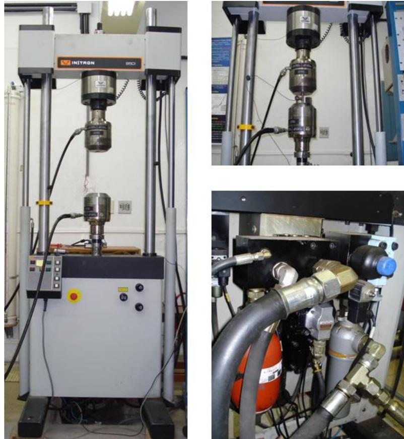
Figura 5.15. Máquina de Ensayos INSTRON 8501.
