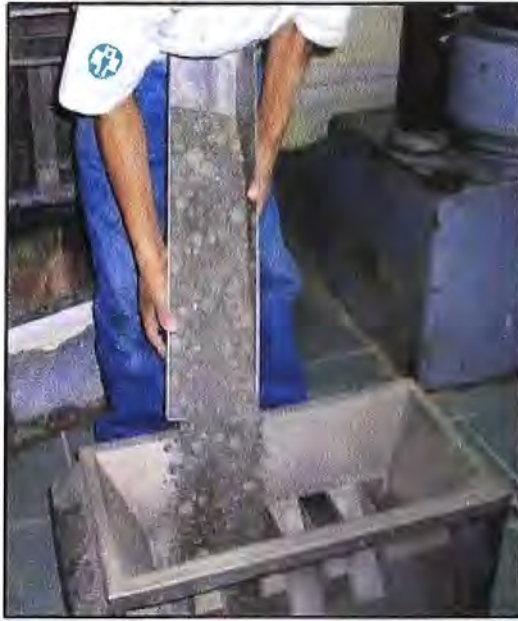
Figura 6.3. Cuarteo de la muestra de clíinker para realizar el tamizado.
