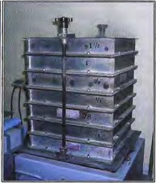
Figura 6.4. Uso de cribas en serie de \sqrt{2} para partículas mayores a 4750 \mu\text{m} .
