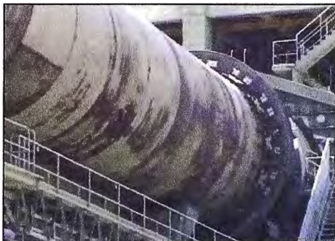
FIGURA VII. Horno Rotativo para la Clinkerización.
