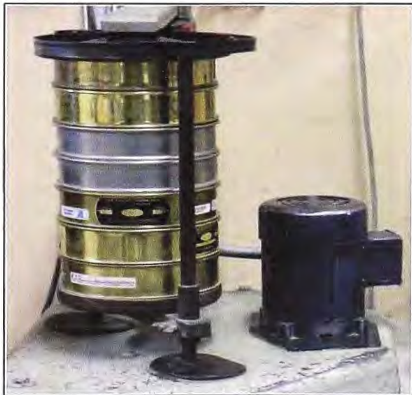
Figura 6.5. Uso de mallas en serie de \sqrt{2} para partículas menores a 4750 \mu\text{m} y mayores a 100 \mu\text{m} .
