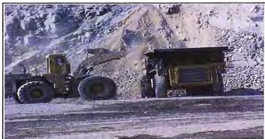
FIGURA III. Cargadores frontales y camiones para el carguío y acarreo.
