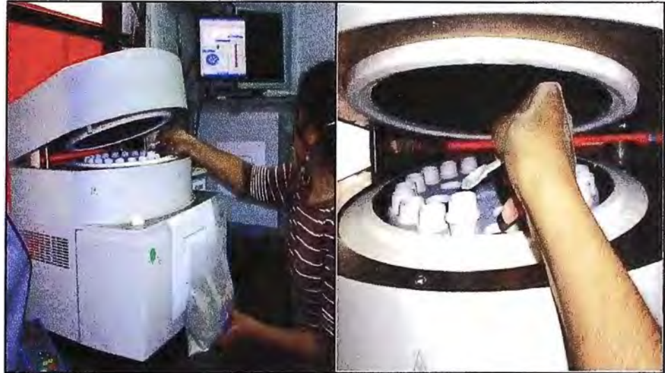
Figura 6.17. Termogravímetro para determinar la pérdida por ignición de la muestra.
