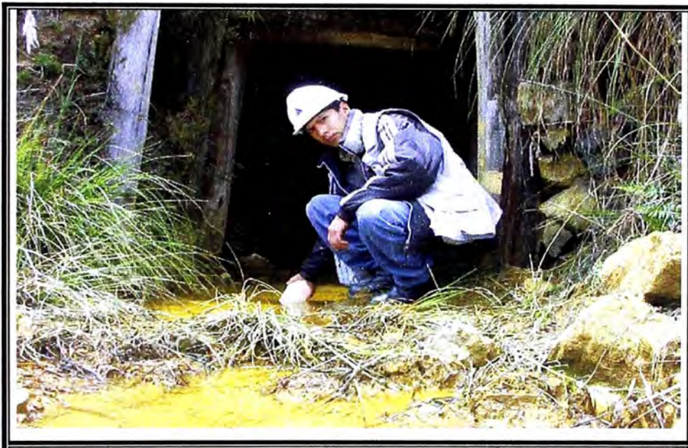
Figura No 3.01: Muestreo del drenaje ácido de una bocamina con contenido de bacterias acidofílicas
