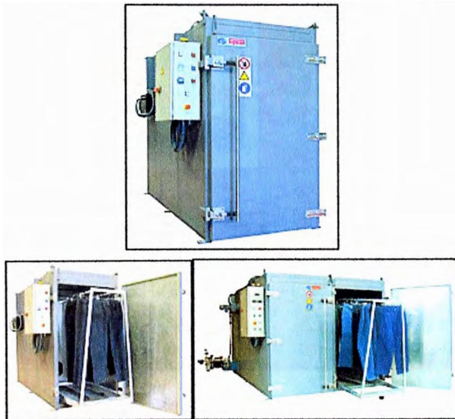
**Arenadora.-**Máquina especialmente diseñada para el arenado de prendas confeccionadas incorpora un sistema de filtrado que garantiza la recuperación total del grano sobrante. Su insonoridad está adecuada según normas
