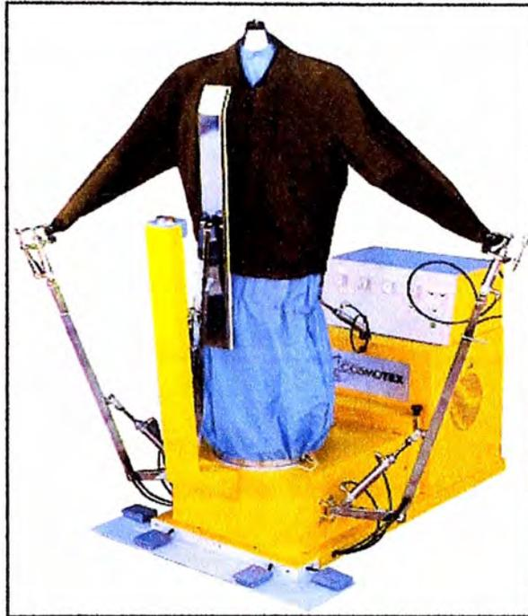
**Planchas.-** El planchado es el tratamiento de acabados que exige más trabajo. Se efectúa solo cuando resulta indispensable. Se procede a un planchado manual o en máquina prensadora. En general se planchan solo las partes (cuellos, bolsillos, cierres, botoneras. Etc.) que presentan aun pliegues después del vaporizado en el “Topper” o el maniquí de planchado.
