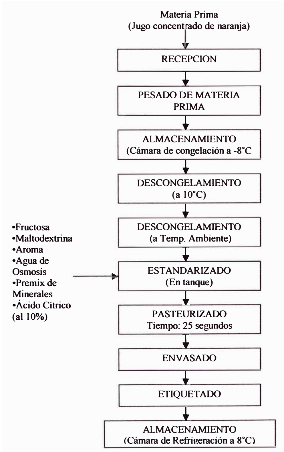
FIGURA 19: Flujo de Operación para la elaboración de una bebida Isotónica en base a zumo concentrado de naranja
