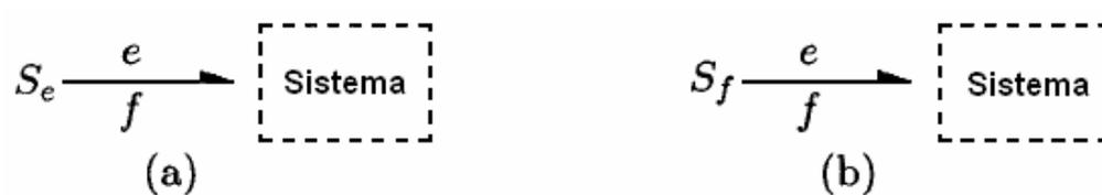
Figura 3.7. Representación de las fuentes de esfuerzo y flujo
