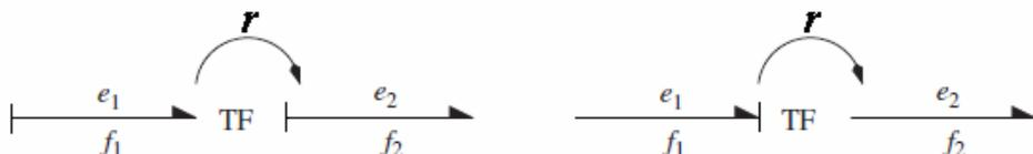
Figura 3.19. Causalidad del transformador
