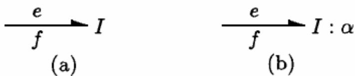
Figura 3.6. Representación de un elemento inductivo
