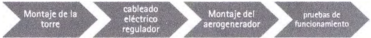
Fig. 4.13 Pasos para realizar un correcto montaje del aerogenerador
