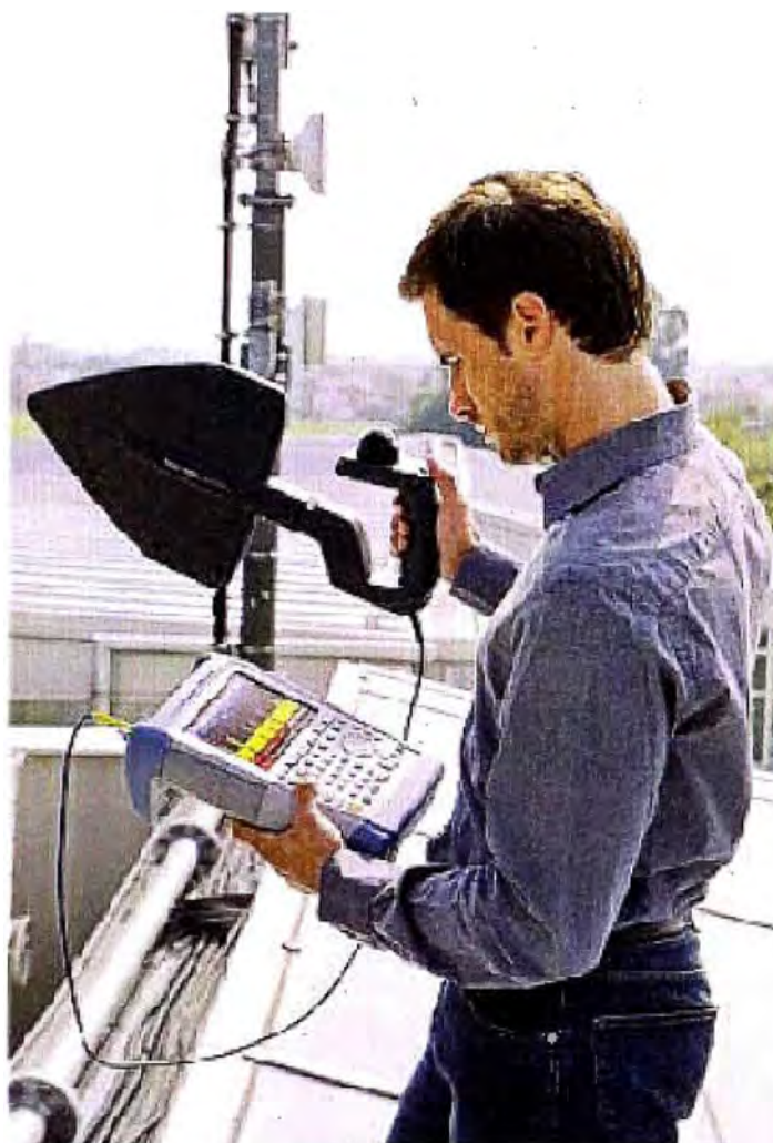
Figura 2.5 Técnica manual con antena giratoria
