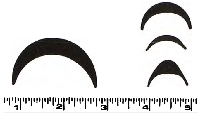
Fig. 2.11 Sección de perfil de hielo artificial en forma de media luna [2].
