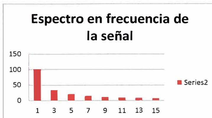
Fig.2.4. Espectro de frecuencias de la señal de onda cuadrada
