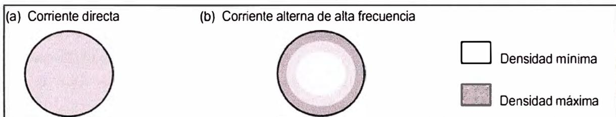
**Fig.2.6.** Densidades de corriente en un mismo conductor, (a) a corriente directa y (b) a corriente de alta frecuencia
