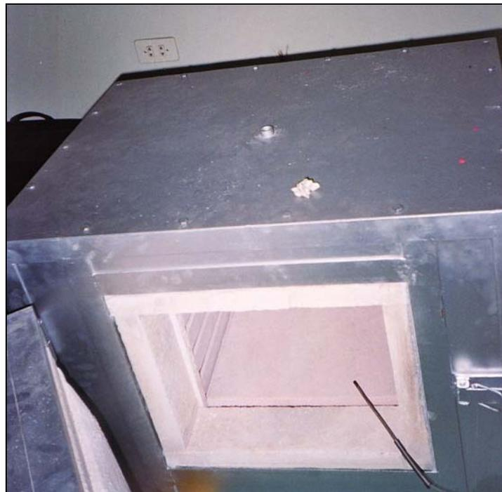
**Figura 2.8 Horno de recocido utilizado en pruebas.**
