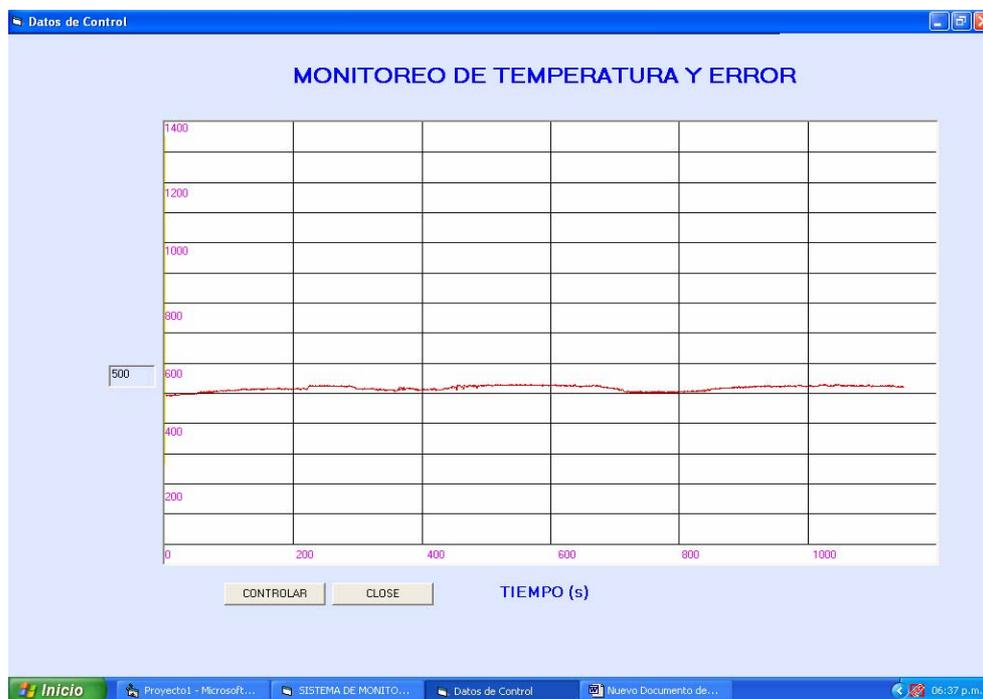
Figura 7.7 Mantenimiento de Temperatura alrededor de la consigna de 500°C.
