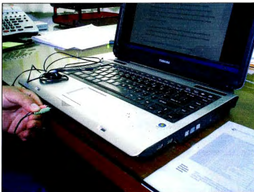
Figura 6.4: Conexión del micrófono a la tarjeta de sonido de la computadora
