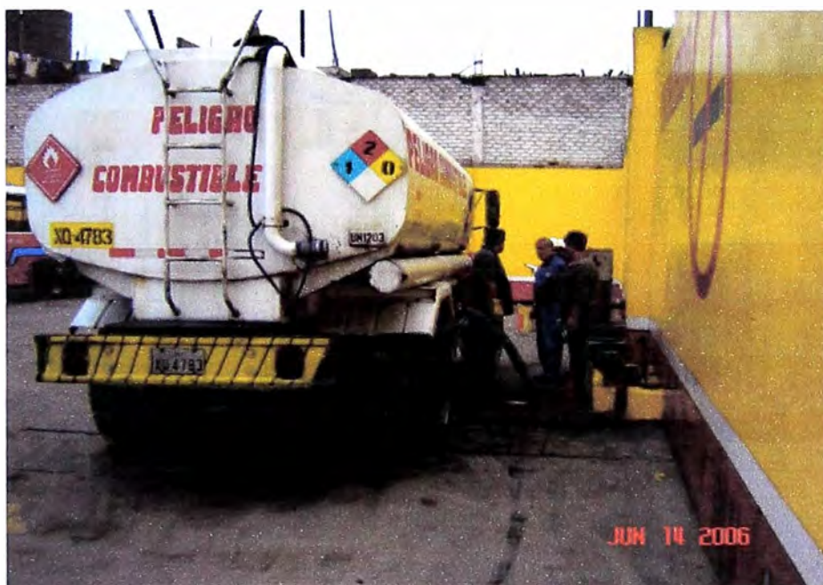
Foto N° 4. Descarga de combustible sin línea a tierra y sin tacos de Seguridad.
