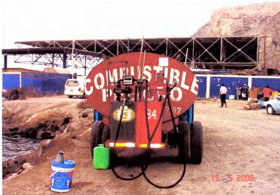
Foto N° 1. Obsérvese que se ha construido un camión cisterna con surtidores (grifo móvil).
