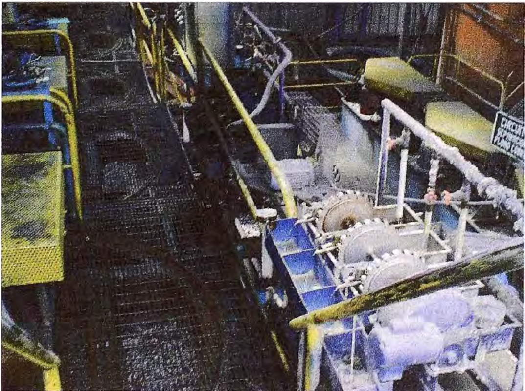
Figura 3.3 Sistema actual de dosificación en Animon con dosificadores de copas.
