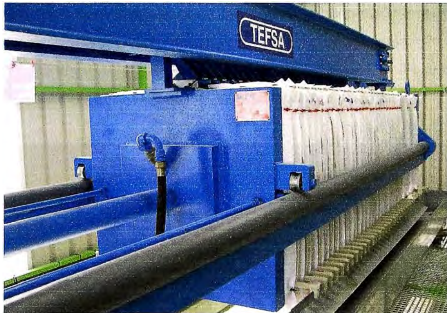
Figura 8. Filtro Prensa Horizontal con sistema automático de traslado de placas
