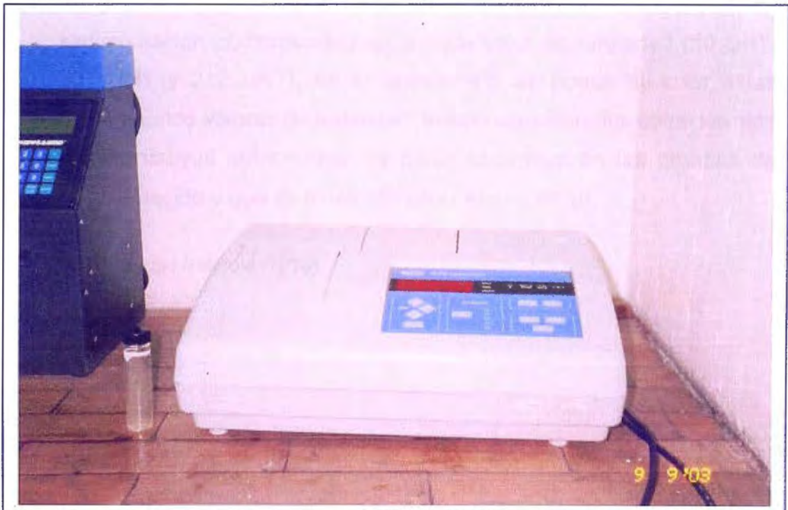
Turbidímetro Nefelométrico : donde se obtuvieron los valores de turbiedad de las muestras analizadas FACULTAD DE INGENIERÍA AMBIENTAL - UNI
