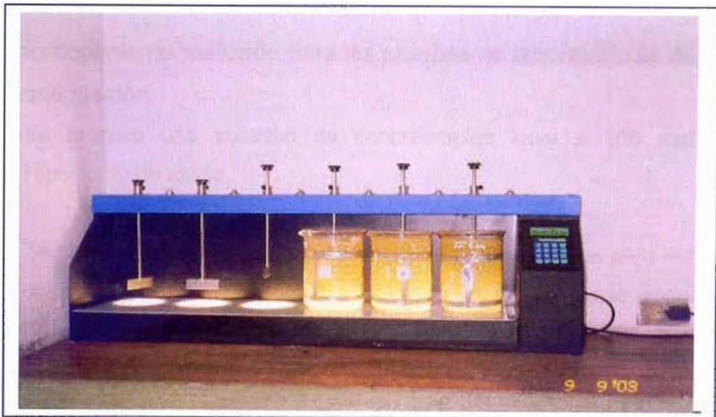
Equipo de prueba de Jarras, donde se realizó la prueba de "Dosis Optima de Desinfectante" FACULTAD DE INGENIERÍA AMBIENTAL
