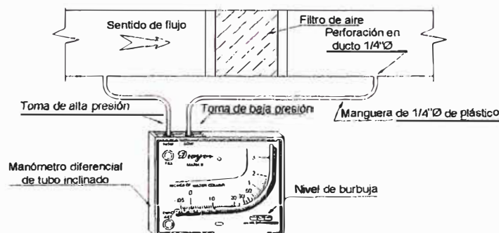
Fig. N° 5.21 Esquema de instalación de manómetro diferencial
