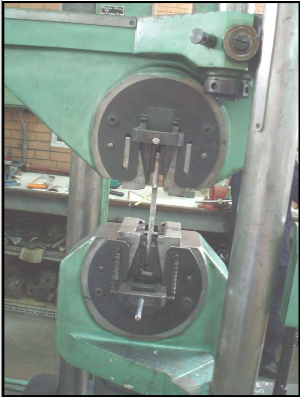
Foto 1: Probeta sometida al ensayo de tracción.
