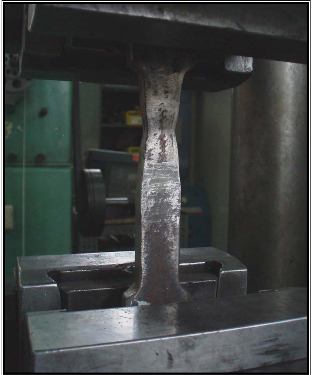
Foto 2. Falla en metal base de menor resistencia (ASTM A36).
