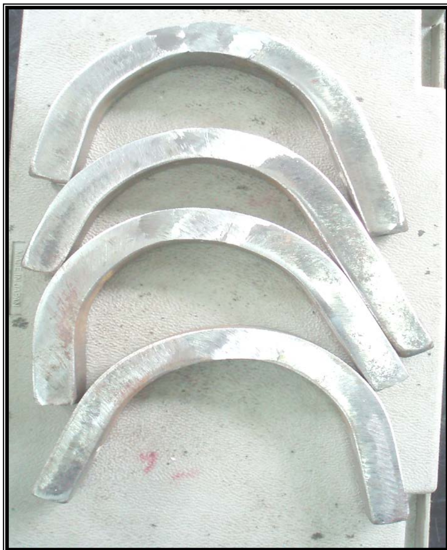
Foto 5: Probetas ya ensayada con doblado de lado. Se puede notar que el acero T1 FORA 500 no se dobla fácilmente en comparación con el acero ASTM A36
