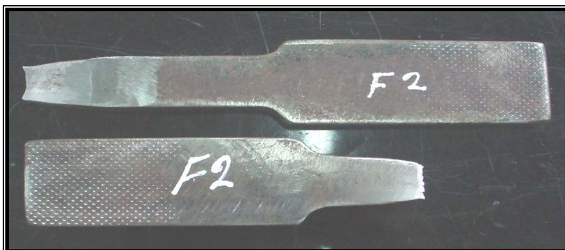
Foto 4: Probeta FCAW 2, fractura dúctil en material base.
