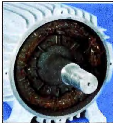
Fig.5.6 Daño causado por un motor bloqueado/amarrado o rotor trabado
