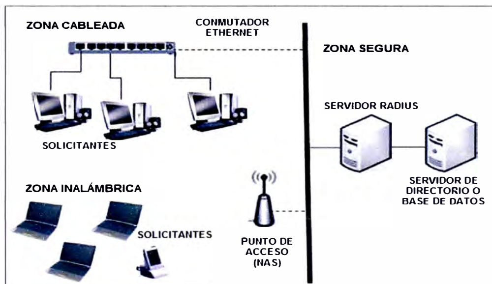
Figura 2.5 Infraestructura simple RADIUS
