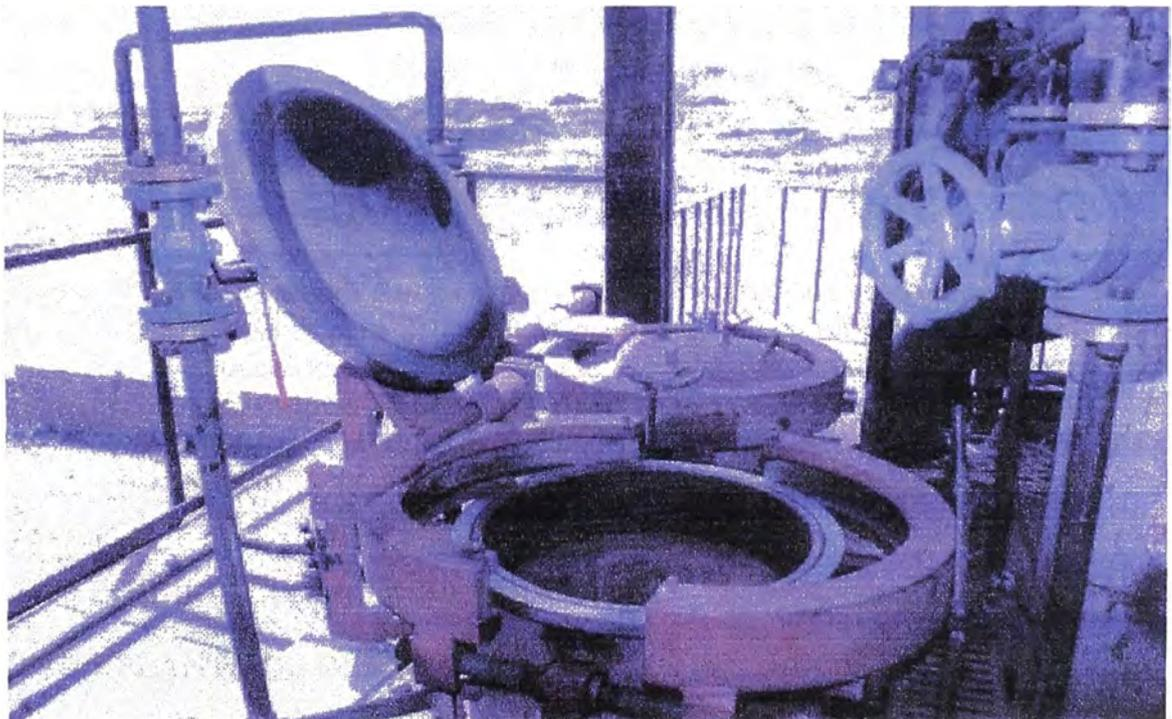
Figura N° 20. La figura muestra la forma como son sellados los extractores en la ESC, sin ningún tipo de perno o brida en la tapa, sino con una corona que selle de manera hermética la tapa con el cuerpo del tanque.
