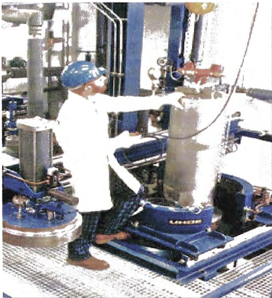
Figura N° 21. Ésta figura muestra la “canastilla portátil” de acero inoxidable 316 L que sirve para depositar la materia prima en un proceso discontinuo o semicontinuo, y en donde se verifica realmente la extracción supercrítica. Obsérvese al lado izquierdo la tapa del extractor, la cual muestra una superficie cilíndrica externa bien pulida, para el ajuste exacto.
