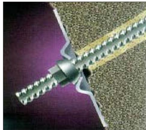
Fig. 7.1.2.2 Perno Helicoidal en Roca
