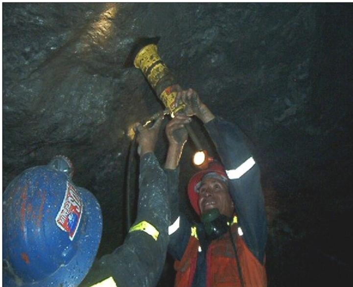
Fig. 7.1.7.1 Prueba de Pull Test
