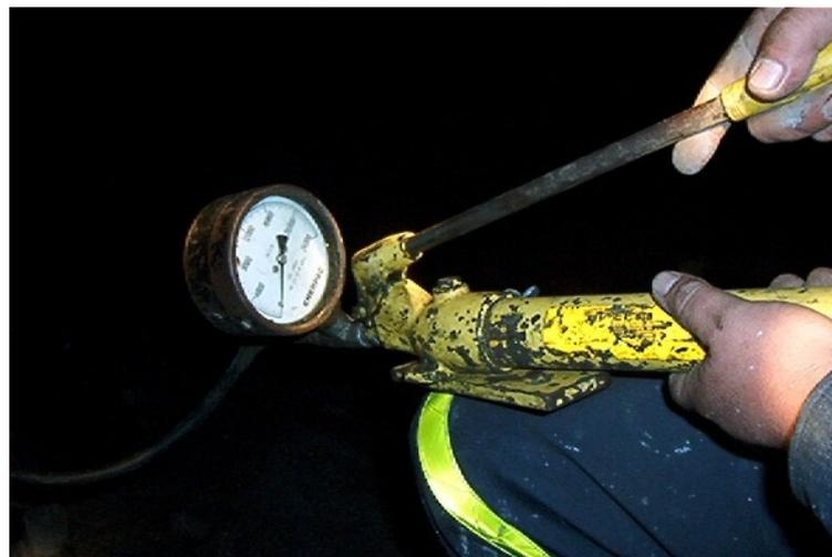
**Fig. 7.1.8.2 Gata Hidráulica con Indicador de carga**
