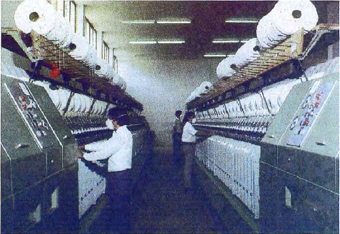
FIGURA 3-2 : CONTINUA DE ASBESTO PROCESANDO HILADO 6 CUT
