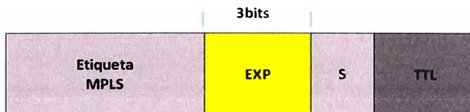
Figura 17. Uso del campo EXP para priorizar el tráfico en Clases de Servicio (CoS).
