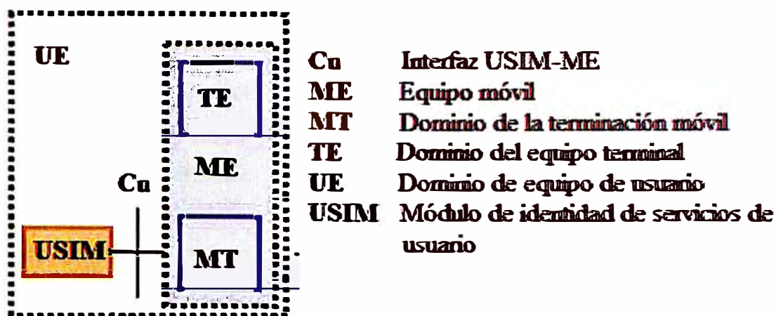
Fig.2.5 Modelo funcional del Equipo de Usuario.
