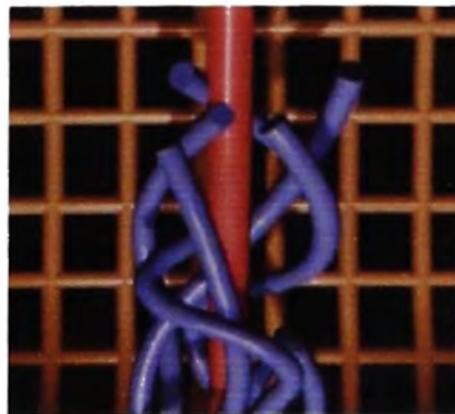
Figura 44: Recubierto por entrelazado
