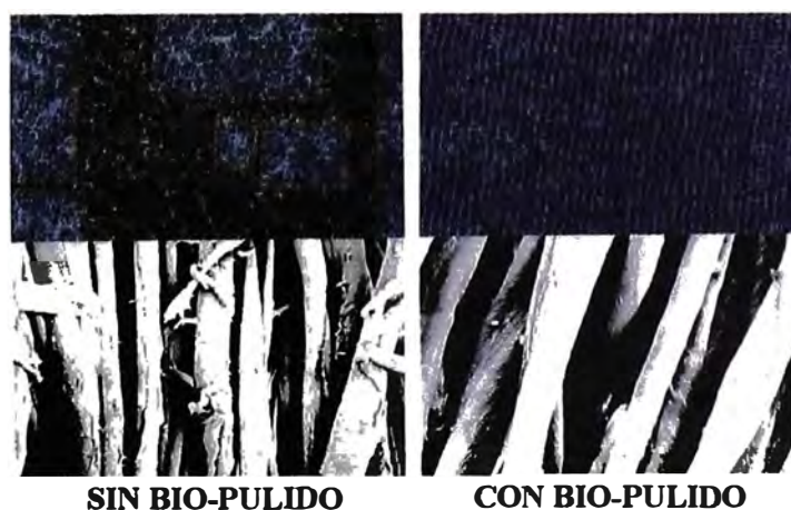
Figura 51: Comparación entre telas con y sin bio-pulido
