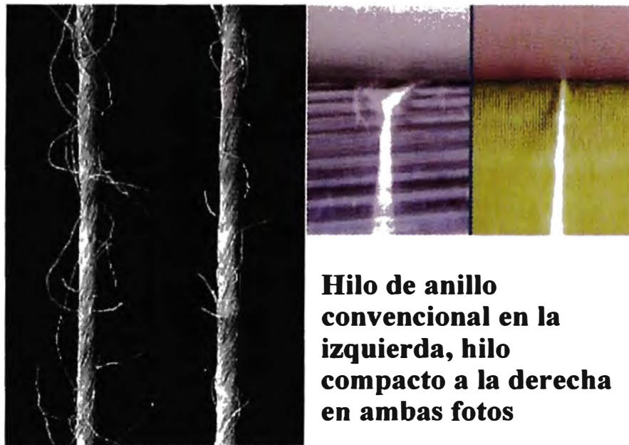
Figura 35: Comparación entre Hilatura Convencional e Hilatura Compacta.
