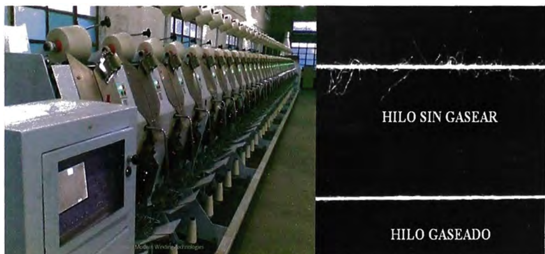
Figura 39: Maquina Gaseadora (izquierda), Comparación de Hilo Gaseado (derecha)
