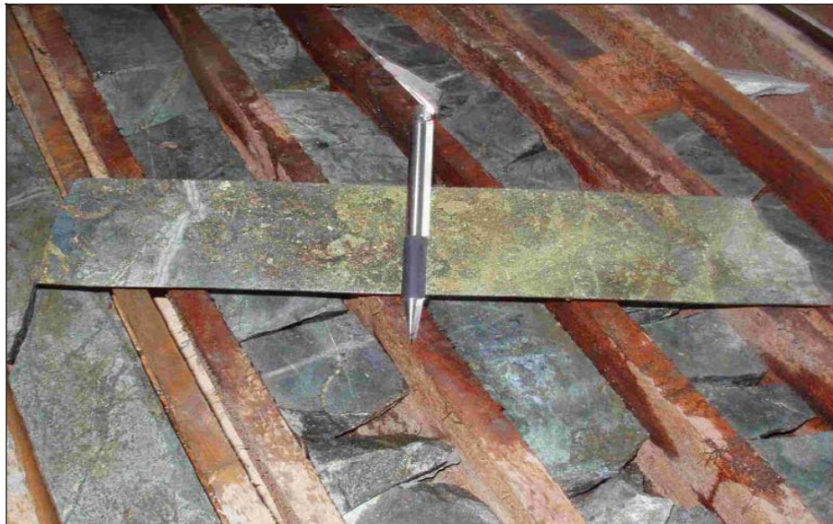
Foto 7: mineralización de cobre en el depósito Petaquilla
