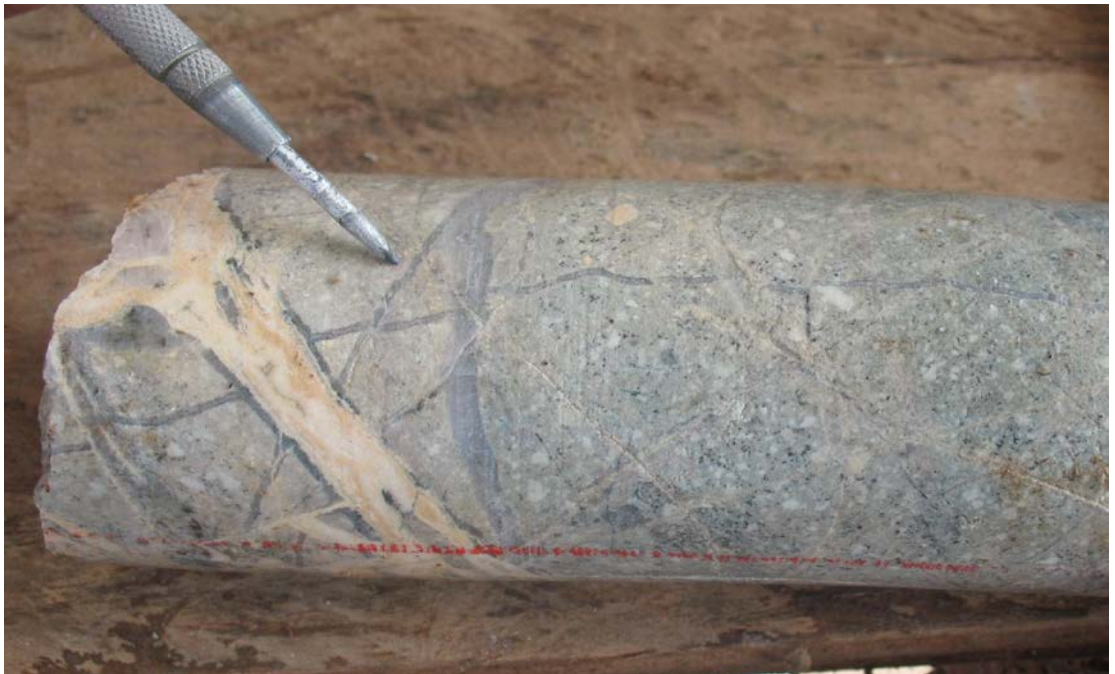
Foto 11: Testigo de perforación con venillas de stockwork de cuarzo
