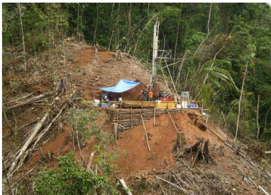
Foto 12: Plataforma de perforación diamantina; pozo B07035
