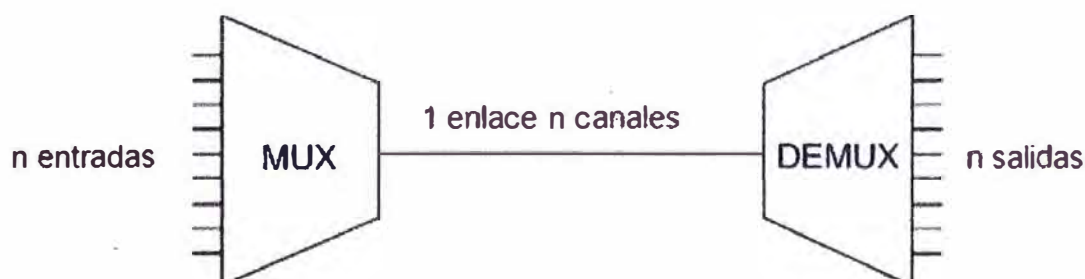
Figura 2.9 Esquema de multiplexor
