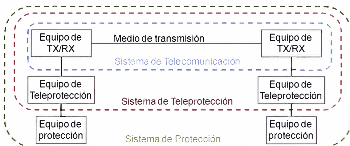
Figura 2.38 Sistema de Protecciones entre subestaciones
