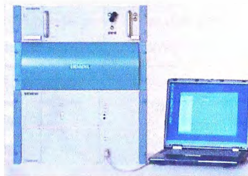
Figura 2.21 Configuración vía PC del Equipo PowerLink
