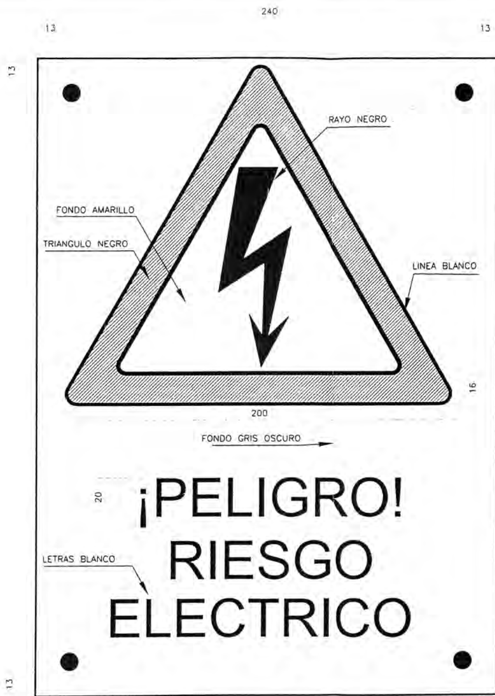
PLACAS DE SEÑALIZACION DE PELIGRO DE MUERTE EN POSTES Escala: 1/2
