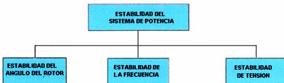
Fig. 1.1 Componentes de Estabilidad de un Sistema de Potencia [1]
