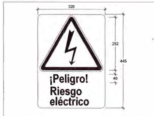
SEÑAL DE RIESGO ELECTRICO ESCALA : 1/10
