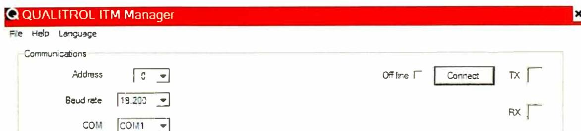
**Fig. 3.13:** Configuración del 509ITM, para comunicación con la PC
