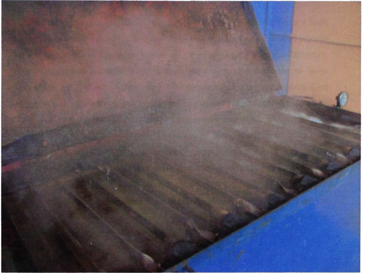
Foto No 9 Celda Electrolítica Abierta
