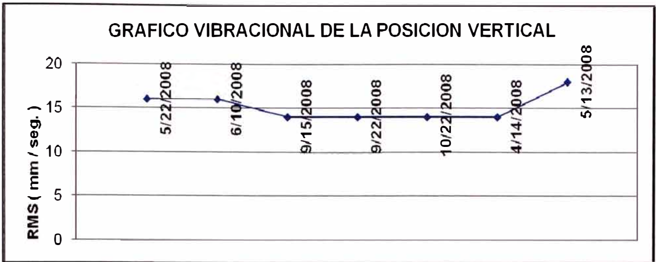
Figura 4.23 Gráfica de vibraciones del turbo compresor (pto 8 lado A) - Posición Vertical
