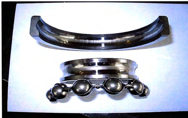
Figura 3.5. Daño prematuro en rodamiento
