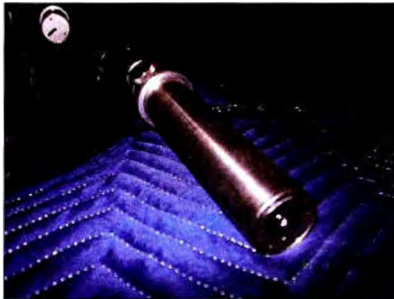
Figura 2.9 Cabezal (printhead) de la impresora Video Jet Excel 170i
