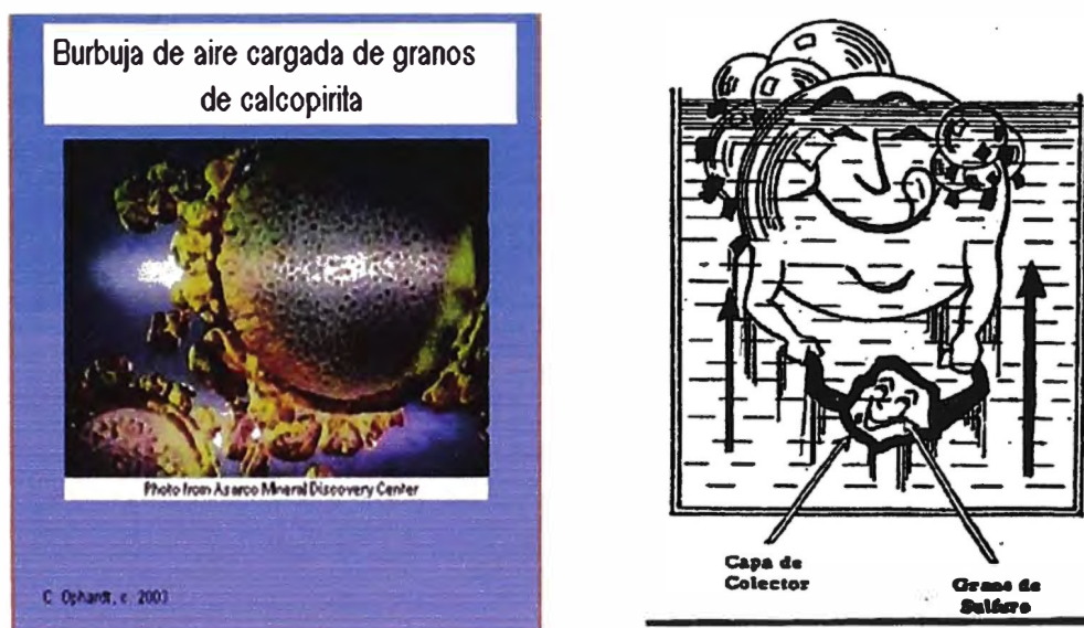
Figura 16: Representación esquemática de la reacción de un colector sobre una partícula mineral de sulfuro.
