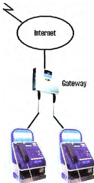
Fig. 4.2. Teléfonos monederos por VoIP
