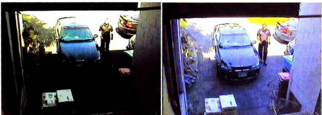
**Figura 3.2.** Cámara sin BLC (izq.) y cámara con BLC (der.)
