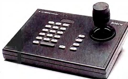
**Figura 3.16** Teclado de control para domos marca BOSCH
