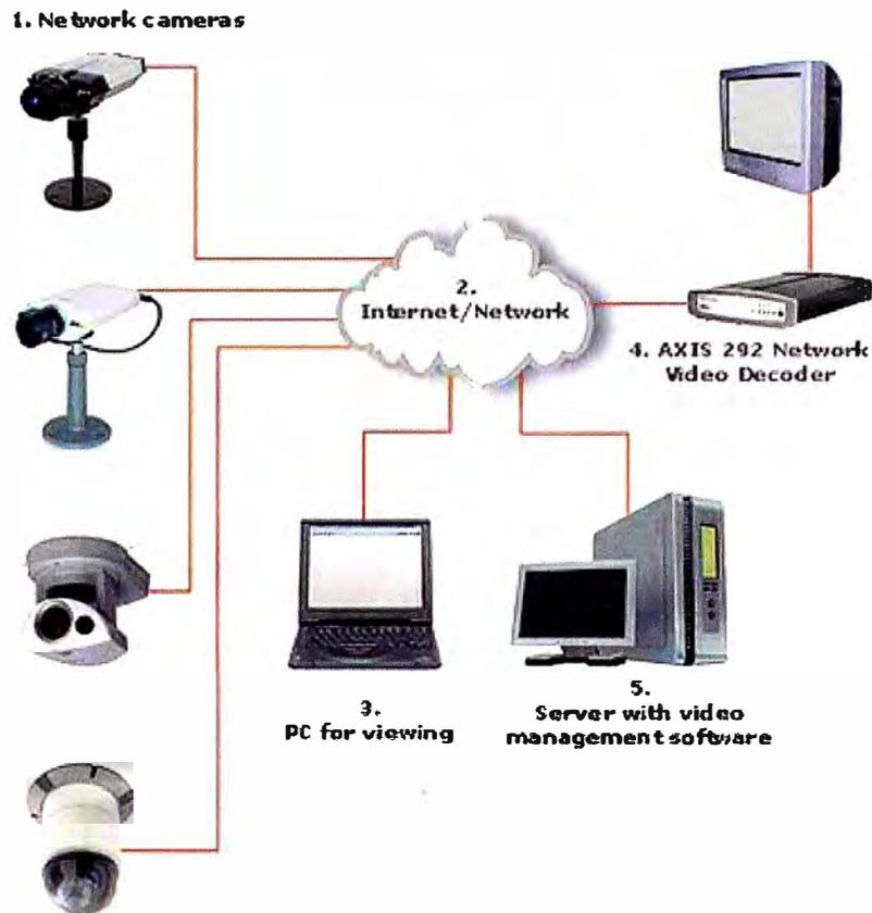
**Figura 2.6** Esquema de un CCTV digital con tecnología IP
