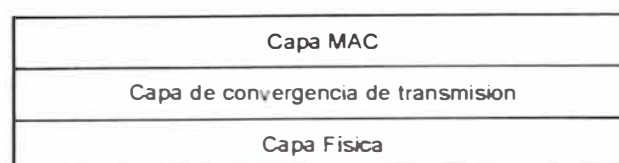
Fig. 1.2.10 Relación de la capa de convergencia con la capa MAC y la capa Física.
