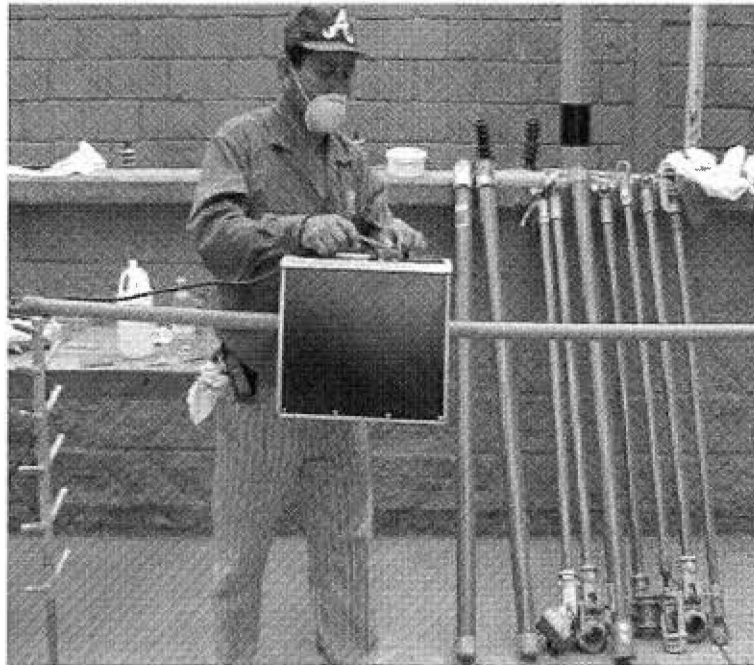
Fig. 2.8 Chequeo de Pértigas.
