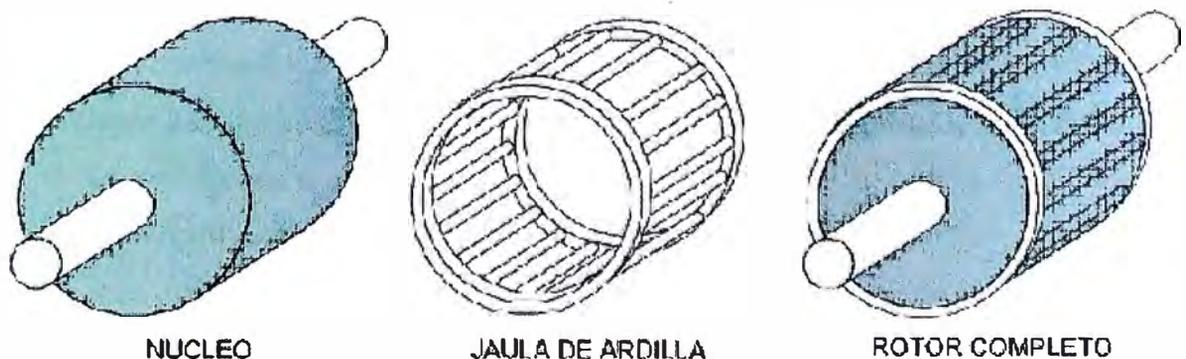
Fig. 3.2 Partes de un rotor
