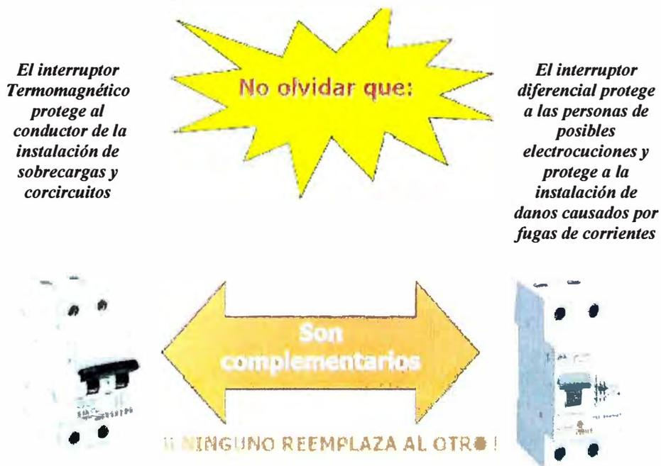
Fig. 3.18 Diferencia entre interruptor magnético y diferencial
