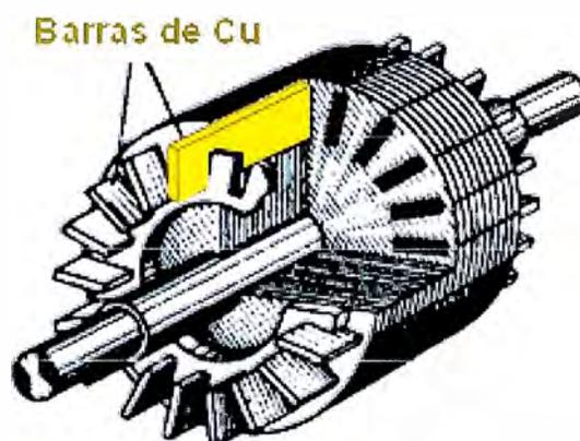
Fig. 3.5 Rotor de Ranuras Profundas
