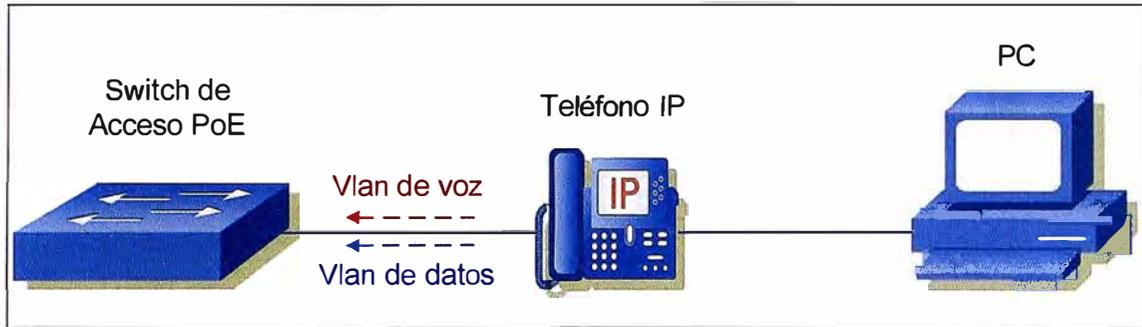
**Fig. 4.6** Diagrama de Conexión de los Teléfonos IP
