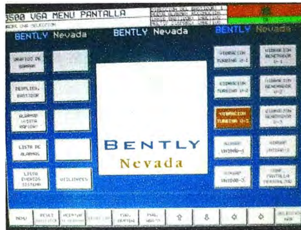
Fig. 3.11 Pantalla 15' de despliegue para del rack 3500
