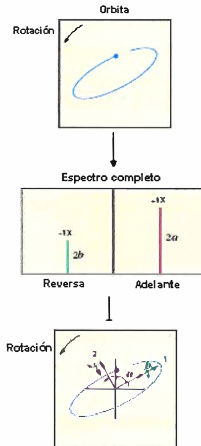
Fig. 2.26 Construcción de una órbita elíptica con los vectores hacia adelante y reversa
