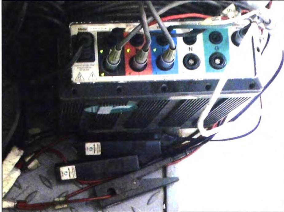
**Fig. 2.9 Registrador Portátil RPM, midiendo calidad de tensión.**
