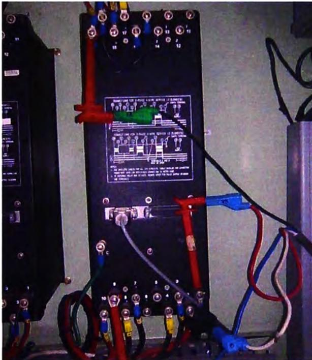
**Fig. 2.6 Registrador conectado en 4W-Y usando cuatro conectores tipo cocodrilo a un medidor marca Schlumberger modelo Quantum.**
