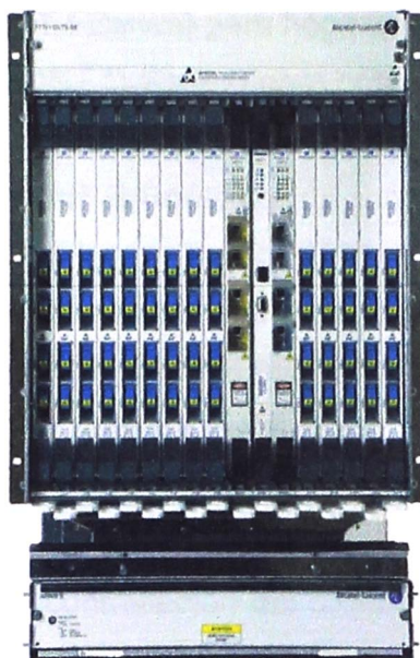
Figura 3.4 OLT Alcatel-Lucent 7342 ISAM FTTU (Fuente: Alcatel-Lucent)
